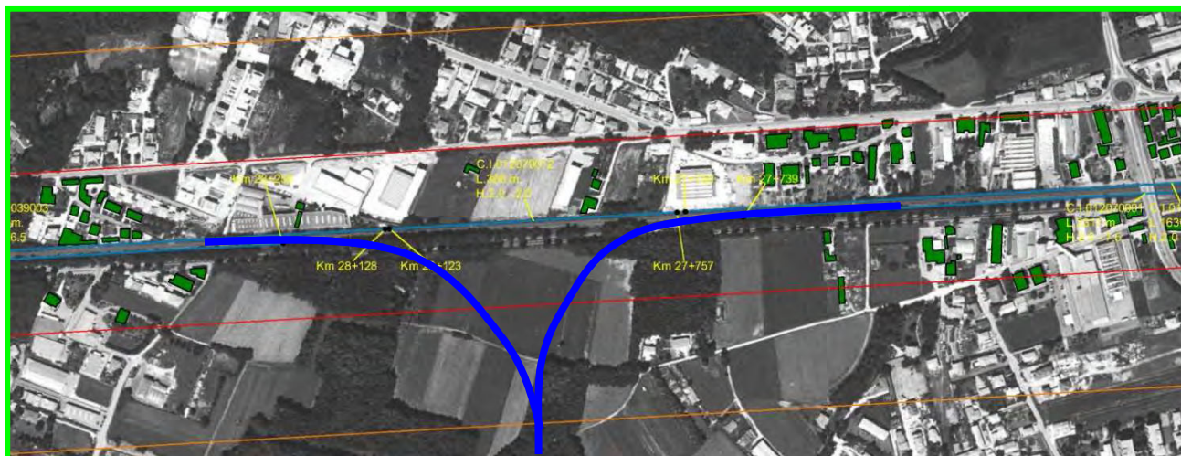
Figura 9-2: Barriere antirumore previste dal Piano RFI (in blu l'intervento in progetto)
