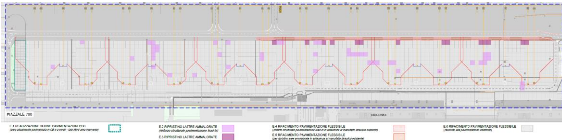
Figura 28: Interventi di ricostruzione delle lastre ammalorate e rinforzo delle lastre ammalorate e della pavimentazione flessibile. Nuove realizzazioni.
